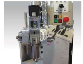
パワーミキサー 特徴: 洗浄タイプ、強制攪拌方式
