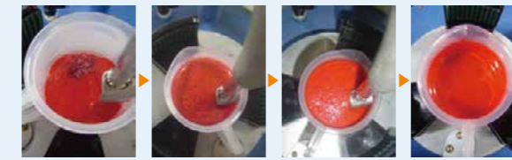
作業前 脱泡攪拌中① 脱泡攪拌中② 作業後
