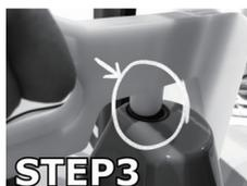
キャリアームの出っ張り部分を攪拌羽根挿入部の穴に合わせます。
